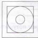
Кнопка включения средств пожарной автоматики
